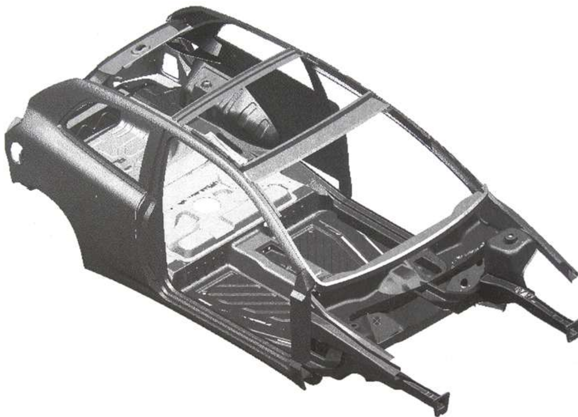
Figura 2.2 - Estrutura unitária monocoque. Adaptado de Genta & Morello (2009).
