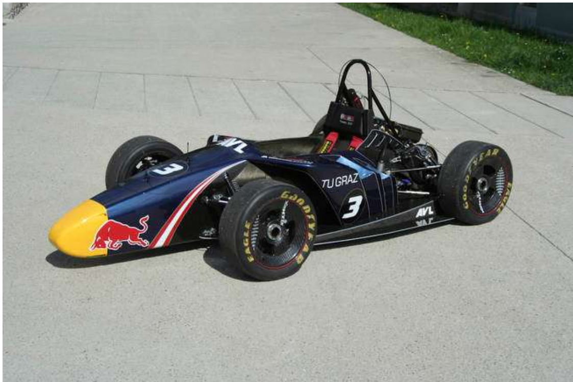
Figura 2.4 - Protótipo de Fórmula SAE (Technische Universität Graz) com estrutura tipo monocoque completo de fibra de carbono.
