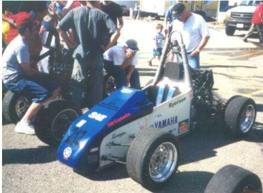
Figura 2.5 – Protótipo de Fórmula SAE (Ryerson University) com estrutura híbrida monocoque-treliçado. A parte dianteira foi feita utilizando-se painéis de alumínio rebitados.
